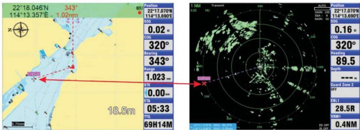
Путевая точка GOTO отображается как на плоттере, так и на экране радара
